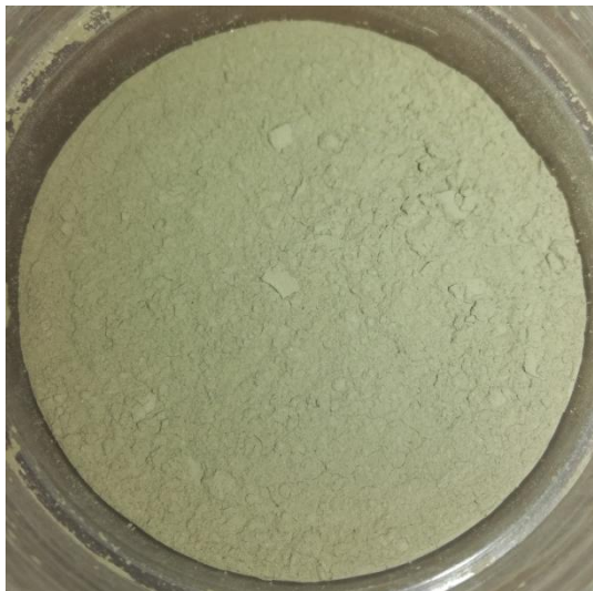
Рисунок 1- Внешний вид образца тонкодисперсного вяжущего порошка микроцемента «КОЛЛОИД»
